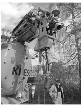
Reinigungsfahrzeug, das zum Spülen der Kanäle vor der Kamerabefahrung eingesetzt wird
